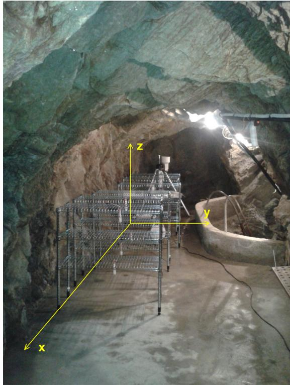
**Figura 3.1.** Scaffali per la posa dei dosimetri durante l'esposizione.
