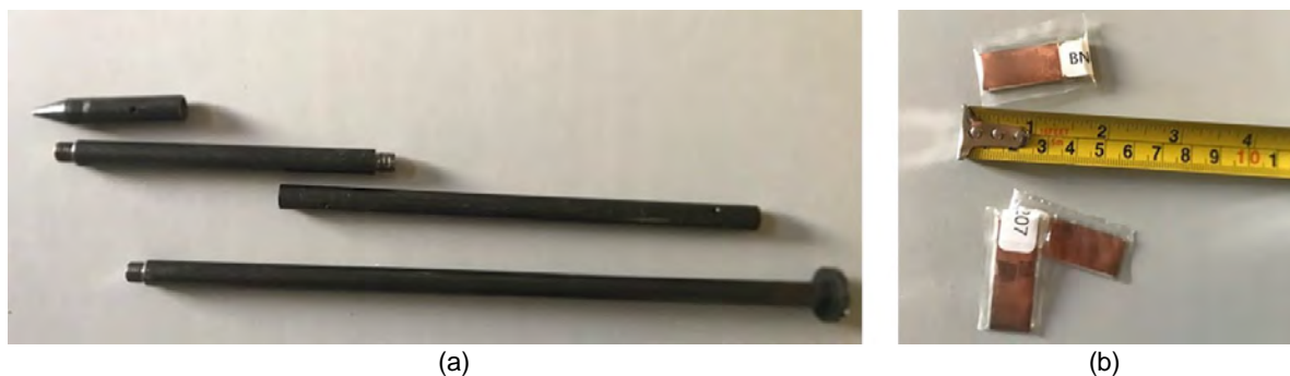
Figura 3 – Puntazza in metallo (a) e dosimetri impiegati per la misurazione del gas radon nel terreno (b)
