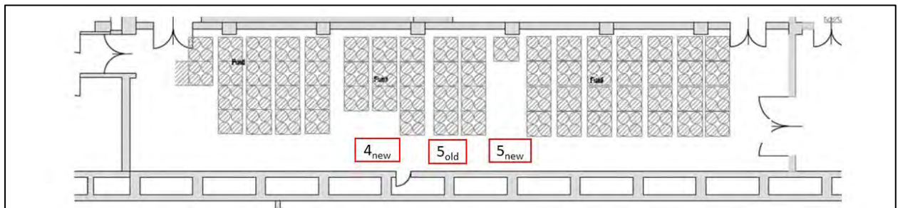
Figura 2: Area di stoccaggio dei rifiuti radioattivi e indicazione dei punti di campionamento dell'aria per il confronto tra procedura standard di campionamento e nuova procedura (rettangoli numerati).
