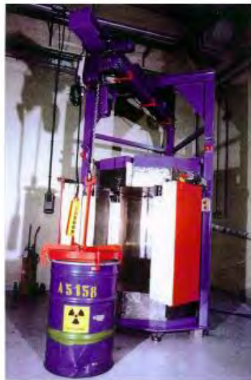
Figura 3 – Sistema neutronico passivo installato presso IPU
