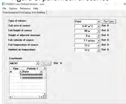
Figura 8: parametri di scarico
