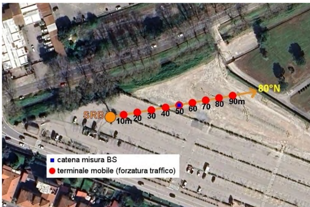
Figura 8 – Foto aerea dell'area oggetto di studio con la posizione del sistema di misura e del terminale di forzatura lungo la direzione di puntamento della cella
