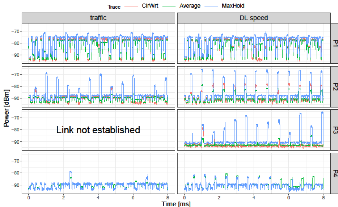
Figura 7. Tracce in ZS con antenna omnidirezionale per ogni tipo di traccia in ogni punto di misura
