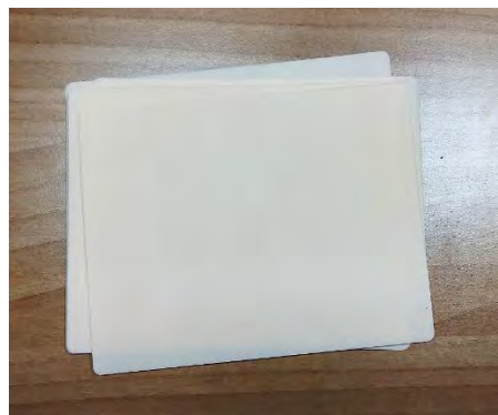
Figura 3 – Pelle sintetica utilizzata per le misure di radianza riflessa. È realizzata interamente in silicone.
