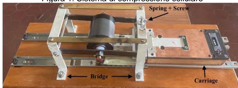
Figura 1: Sistema di compressione cellulare
