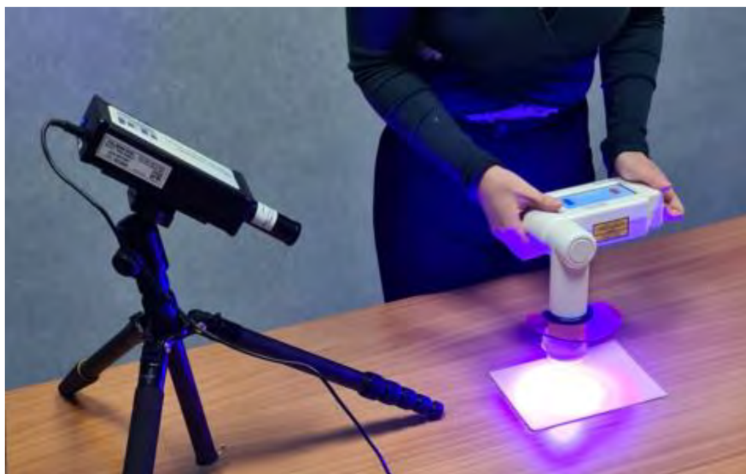
Figura 5 – Radianza riflessa dalla pelle sintetica misurata dallo spettroradiometro Jeti.
