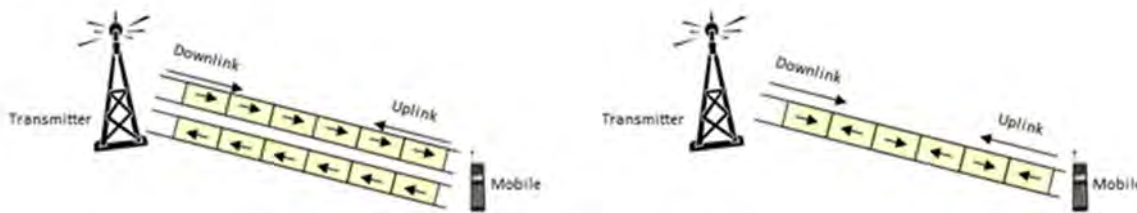
Figura 3 – Gestione della risorsa radio nelle modalità di trasmissione FDD (sx) e TDD (dx)
