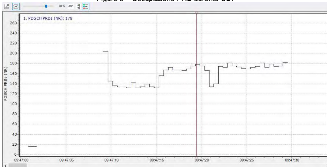
Occupazione di banda in termini di PRB per segnale 5G FR1
