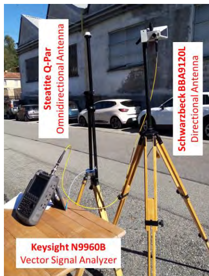
Figura 4 – Antenne di misura e analizzatore di spettro vettoriale
