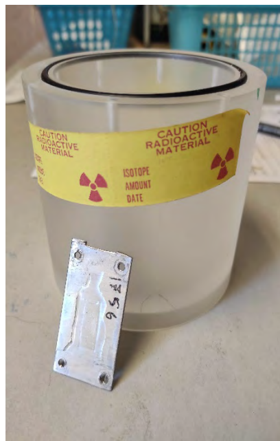
Fig.4 – Sorgente di Radio a targhetta da 6,5 kBq
