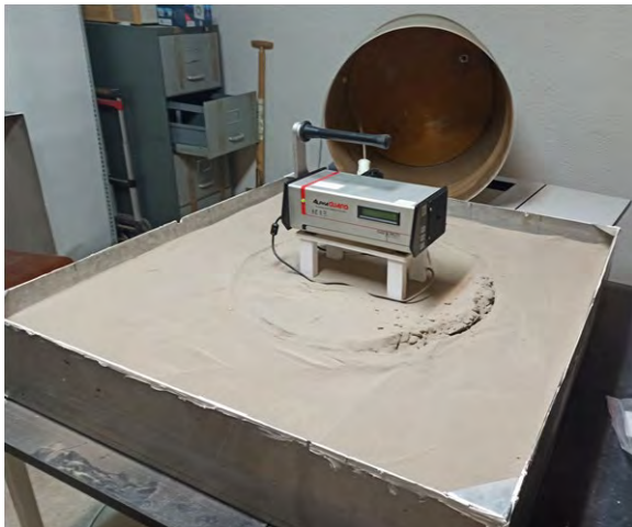
Fig. 6 – «Exhalation bed» con il monitor AlphaGuard
