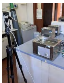
Figura 1 - Set up di misura per la rilevazione degli ultrasuoni durante la campagna
