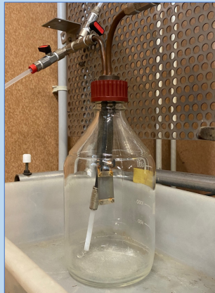
Fig. 2 la sorgente di Ra-226 è costituita da Sali di radio inglobati in una matrice siliconica che permette la diffusione del radon, ma previene la dispersione del radio.
