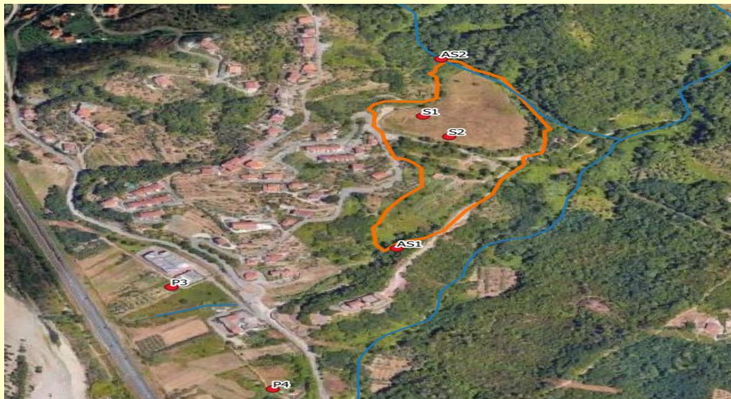
S1 e S2, piezometri all'interno della discarica (9 prelievi) AS1 e AS2, postazioni di verifica delle acque superficiali poste immediatamente prima e dopo il by-pass (10 prelievi) P3 e P4, pozzi d'acqua privati (8 prelievi)
