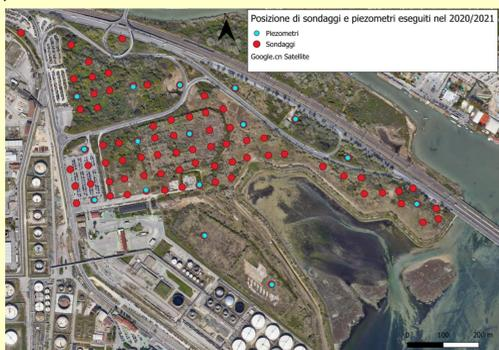
Tra le diverse indagini, sono state prelevate 82 carote di materiale con studio delle stratigrafie ed analisi chimica degli strati, dalla quale si sono ravvisati la presenza di strato continuo (spessore 1.2 - 4.1 m) di fosfogessi e altri rifiuti industriali e il superamento delle concentrazioni soglia di contaminazione di alcuni parametri.
